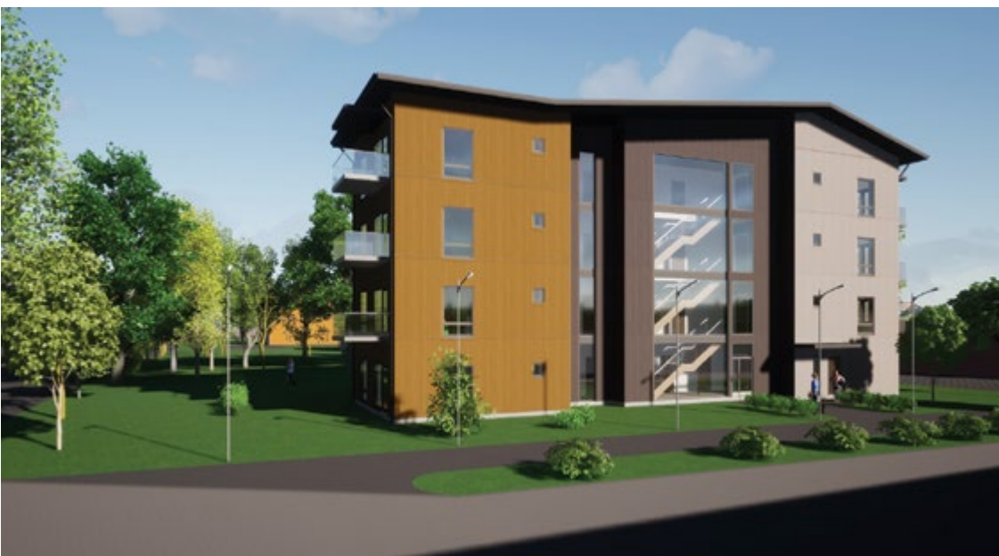
Havainnekuva hankkeessa suunnitellusta CLT-moduulirakenteisesta puukerrostalosta.
